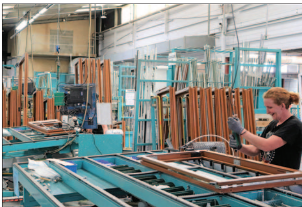
Vu le nombre d'options possibles pour le sur-mesure, le ferrage des ouvrants n'est pas automatisable. Ici, l'un des trois postes de ferrage ouvrants.
