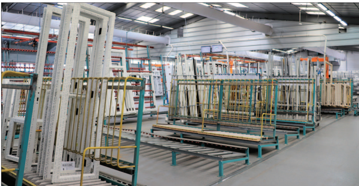
La transitique manuelle de la ligne des ouvrants.
