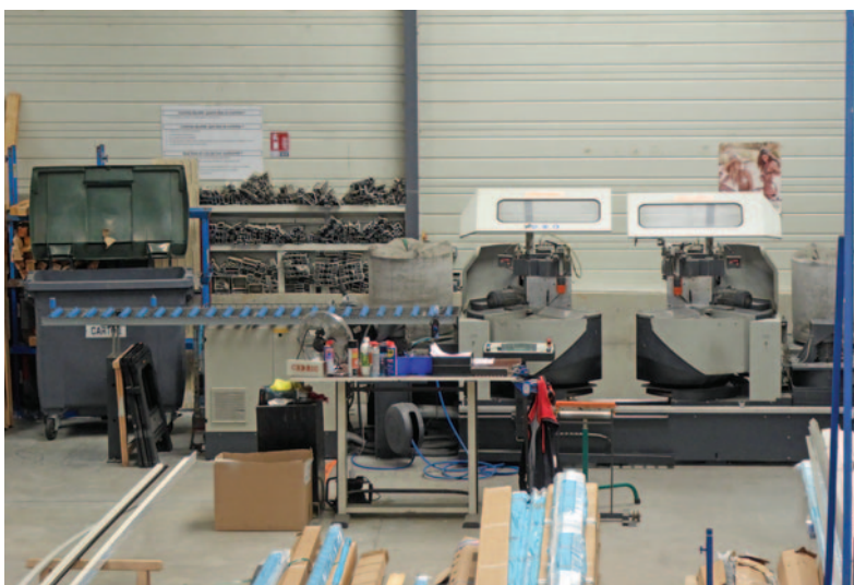
Le centre d'usinage et cette machine "deux têtes" elumatec sont pilotés par une même personne.
