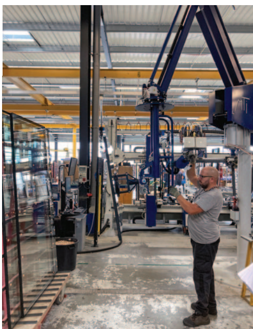
Poste de vitrage avec palonnier à ventouses pour sécuriser les manipulations de vitrages lourds.
