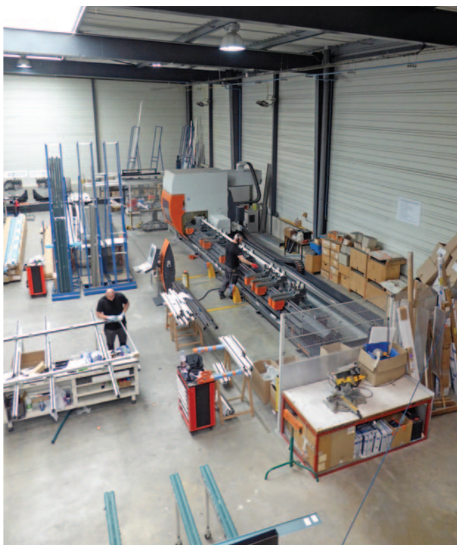
Le centre d'usinage et cette machine "deux têtes" elumatec sont pilotés par une même personne.
