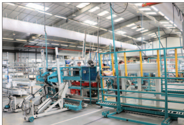
Un poste d'assemblage des coffres de volets roulants (Sopropfen).
