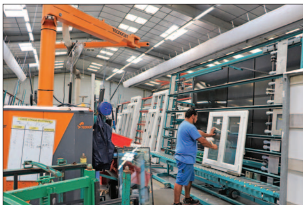
L'un des trois postes de vitrage. Les plus grandes menuiseries mesurent 4,5 X 2,8 m.
