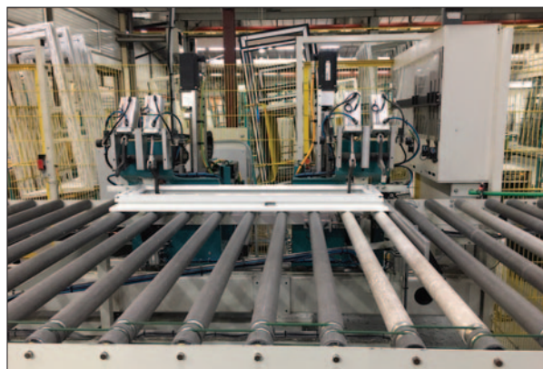
Différentes finitions de soudure sont réalisées en fonction de la commande. Ici, les soudures d'un cadre sont en cours d'ébavurage.
