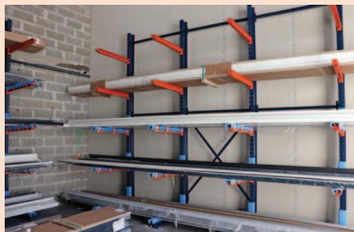
Le **stock tampon** de profils Sapa, des barres de 6,5 m.
