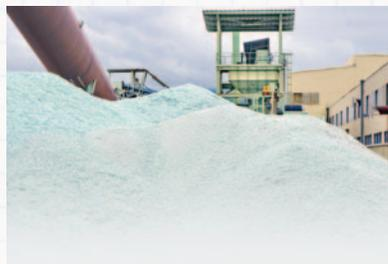
Les **vitrages isolants** (doubles ou triples) doivent être orientés vers une **unité de recyclage de vitrages** qualifiée pour la **préparation de calcin** de verre plat.
