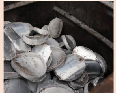
Les chutes de profilés comme les chutes de billette sont **recyclées en externe**. 70 % de tout l'aluminium créé jusqu'à présent dans le monde sont toujours en circulation. Refondre l'aluminium recyclé ne nécessite que 5 % de l'énergie utilisée lors de la production d'aluminium primaire.
