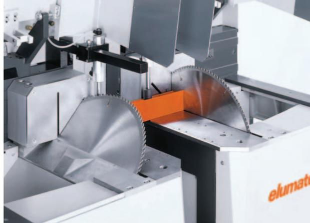
6 000 mm. La double scie à onglets répond aux besoins individuels des clients grâce à des options telles que des imprimantes d'étiquettes, des extensions de logiciel, des convoyeurs à rouleaux ou le dispositif de pulvérisation de dosage. ■
