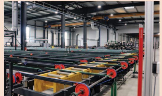
Elle sera environnée de **plusieurs ateliers périphériques,** plus resserrés que dans la configuration actuelle, ce qui optimisera les déplacements des profils. Dès leur sortie du four, ces derniers seront aiguillés vers les ateliers via des convoyeurs. Cette modernisation ne réduit pas pour autant le nombre d'opérateurs.
