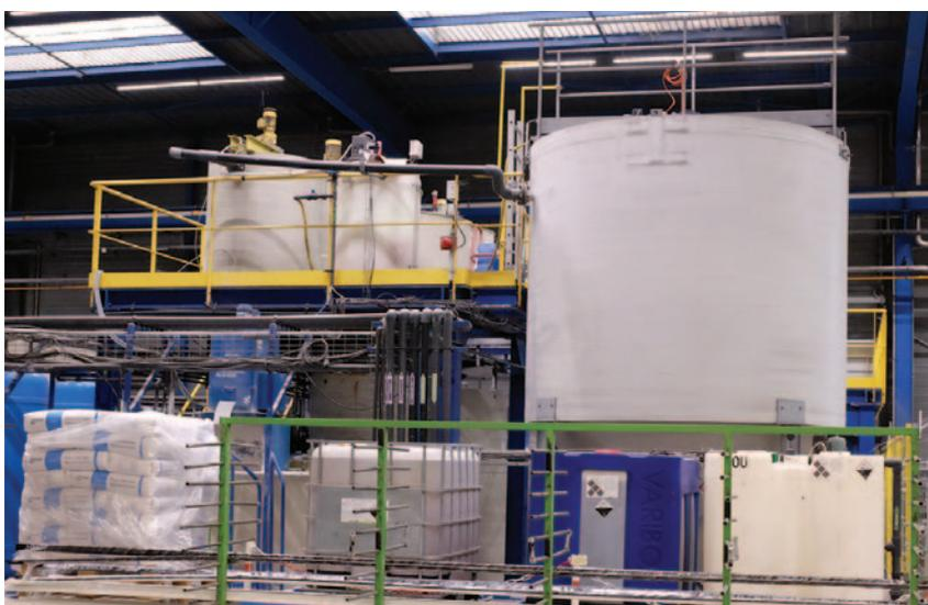
L'eau utilisée pour le process de laquage est envoyée dans une petite station d'épuration (STEP) pour être nettoyée et réutilisée. Des travaux ont été effectués en 2019 pour pouvoir réutiliser l'eau nettoyée. Ainsi la consommation d'eau sur l'ensemble du process a été divisée par deux par rapport à l'année précédente, ce qui fait 18 m<sup>3</sup> d'eau économisés chaque jour.
