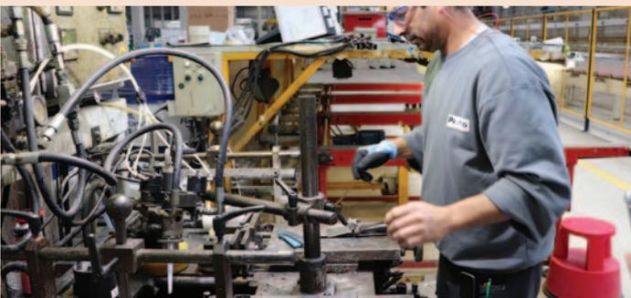
**L'atelier de résinage :** Profils Systèmes est le seul gammiste français à utiliser ce procédé, qui apporte une très bonne rigidité en même temps qu'une parfaite rupture de pont thermique. Une résine polyuréthane est coulée dans la gorge du profil, destiné à fabriquer des seuils de porte.
