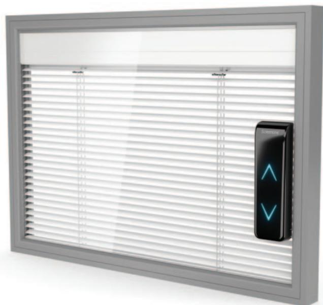
La nouvelle version du dispositif de contrôle du système motorisé "W". Ce modèle de store permet le relevage et l'orientation d'un store à l'intérieur d'un vitrage isolant de 20, 22, 27, 29 ou 32 mm à travers un moteur, inséré dans le caisson supérieur, qui est alimenté par une batterie rechargeable au réseau ou en exploitant l'énergie accumulée par un panneau solaire externe, et pouvant être contrôlé par une télécommande.
