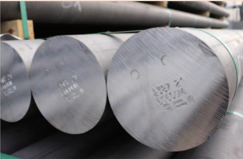
Chaque billette en alliage 6060 qualité bâtiment, à faible contenu carbone, est chauffée à 450 degrés avant d'être coupée en tronçons et d'entrer dans la presse.
