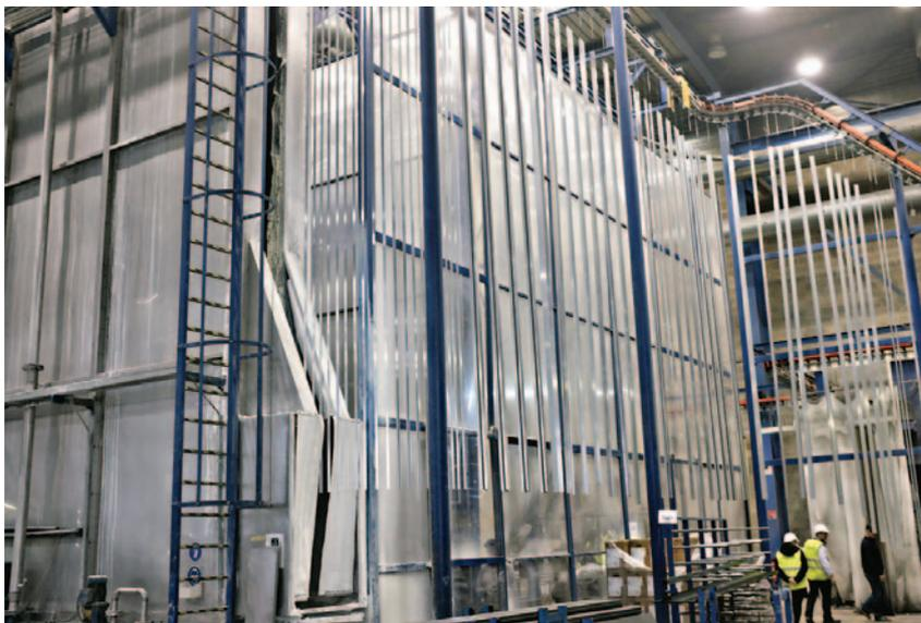
Ligne de laquage vertical de marque SAT, suivie du séchage, poudrage et polymérisation. Une deuxième ligne de laquage du même fabricant est prévue dans la nouvelle extension.
