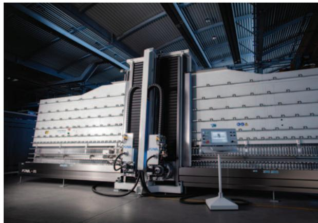
La vitesse de façonnage peut arriver à 300 mm/sec. Epaisseur du verre usinable de 3 à 20 mm.
