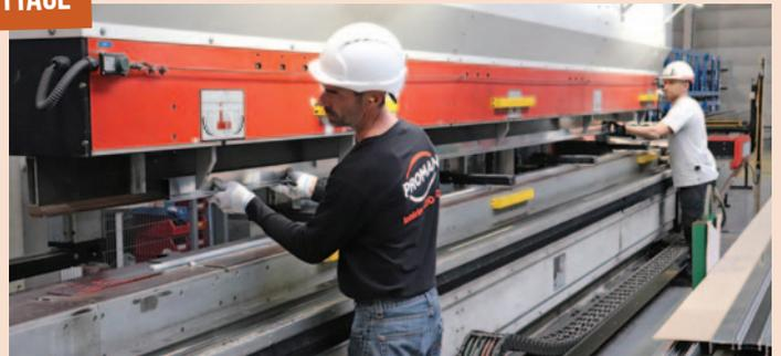
L'une des deux machines utilisées pour le **barettage**.
