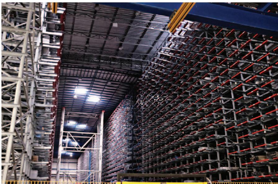
**Transstockeur de marque Dimassima.** Le local a été construit sur mesure avec 15 mètres sous plafond et 18 mètres pour les transstockeurs avec dérogation du PLU.
