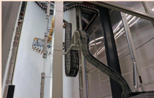
**Le nouveau bâtiment :** dans ses 5000 m<sup>2</sup>, une nouvelle unité de laquage verticale est en cours d'installation, équipée de matériel italien SAT et de pistolets Gema.
