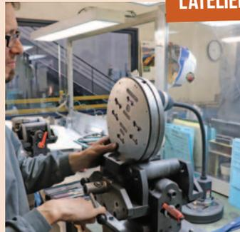
Les filières en acier nécessaires à l'extrusion des profils sont **réglées manuellement** : limées et fraisées avec minutie, elles sont testées pour obtenir le profil parfait.
