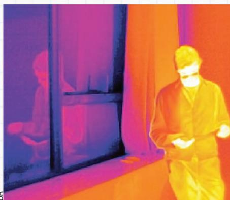
La thermographie infrarouge montre l'impact du rayonnement sur le transfert de chaleur et la température ressentie. Ici le corps chaud de l'occupant est refroidi par la paroi froide (teinte plus sombre du côté orienté vers la vitre).
