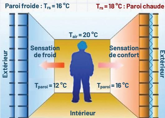
Les inconforts liés à l'enveloppe sont principalement dus à l'asymétrie du rayonnement : un écart trop important entre la température intérieure et extérieure. Ces inconforts locaux peuvent être liés aux parois froides (vitrage, murs extérieurs mal isolé, plafond et/ou plancher rafraîchissant) ou aux parois chaudes (vitrage ensoleillé, plafond ou plancher chauffant, émetteur de chaleur rayonnant).
