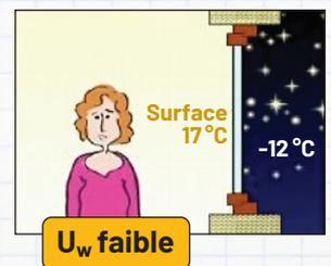
Pour autant, trop de chaleur en été est aussi source d'inconfort. On s'attachera à garantir la fraîcheur de la pièce, soit en couplant le U<sub>w</sub> de la fenêtre au facteur solaire S<sub>w</sub> le plus faible possible afin de couper un maximum d'énergie solaire non maîtrisée, soit en ajoutant une protection solaire extérieure (volets, stores, rideaux...).
