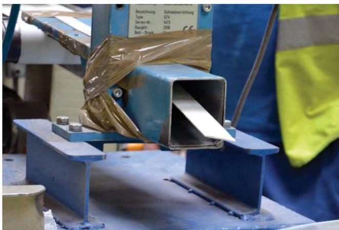
**Extrusion** d'une languette de PVC pour l'analyse en laboratoire.
