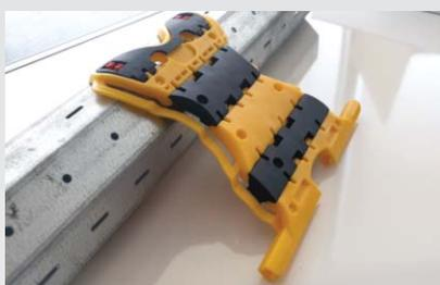
Ce verrou pour volet roulant de Guyenne Plastique permet le verrouillage en position basse des tabliers manœuvrés par treuils ou moteur (puissance maxi conseillée 25 Nm suivant la typologie de moteurs). Grâce à son faible encombrement, ce verrou est particulièrement destiné à une utilisation dans les concepts où les volumes sont parfaitement optimisés. Le choix du nombre de maillons est
