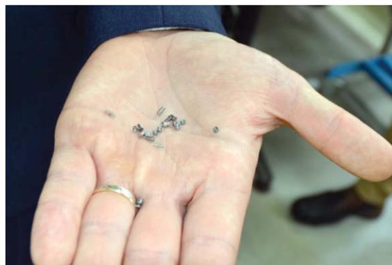
Quelques goupilles et ressorts à insérer dans un rotor
