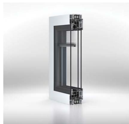
La fenêtre se distingue par l'intégration d'un système respirant qui fait la différence. Une parclose perforée avec un filtre en acier inoxydable est dissimulée et intégrée dans la partie supérieure de l'ouvrant extérieur afin d'éliminer l'embuage et la condensation.
