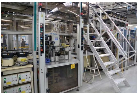
Machine pour le **goupillage** final des cylindres préassemblés
