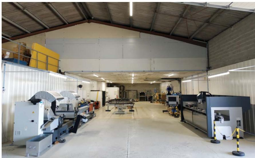
Le nouvel atelier de fabrication, avec à gauche, la **scie Schüco PDG CUT 550 5 M**, et à droite le **centre d'usinage Schüco AF210**
