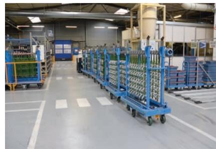
Train autonome dans l'atelier de polissage
