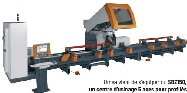
Umea vient de s'équiper du **SBZ150, un centre d'usinage 5 axes pour profilés de grandes dimensions**, équipé d'une broche d'usinage d'une puissance de 15KW S1, pouvant travailler sur l'ensemble des faces du profilé y compris par le bas. Le centre dispose d'un changeur d'outil automatique et embarqué pouvant contenir 14 outils et une lame de scie pour les sciages complexes en bout de profilés.
