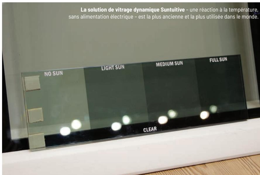
La solution de vitrage dynamique Suntuitive – une réaction à la température, sans alimentation électrique – est la plus ancienne et la plus utilisée dans le monde.
