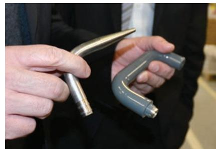
Béquille nue et béquille équipée par injection de plastique
