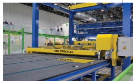
même temps et est dotée d'un deuxième étage pour soulever le verre au-dessus de la machine après la coupe, le pivoter pour une deuxième coupe, et ainsi accélérer le processus en optimisant le banc de coupe. Elle peut travailler des épaisseurs de verres de 2x2 mm à 2x8 mm, et une épaisseur de film de 0,38 mm à 3,8 mm, à une vitesse de 140 m/min. La longueur maximale de coupe est de 4 600 mm. ■
