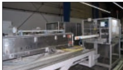
Extrusion des profilés PVC
