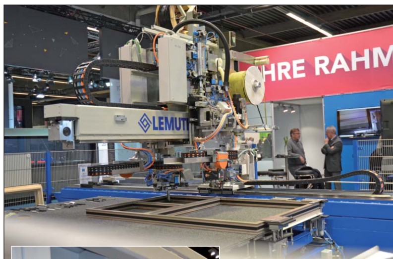
Machine à poser les joints ou les films double face pour coller les vitrages.
