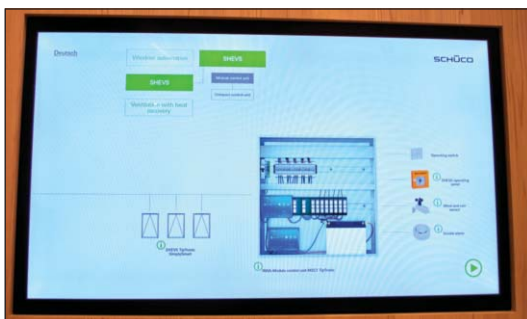
En proposant une interface des ses motorisations vers BACnet sur IP, Schüco manifeste clairement sa volonté de proposer ses façades techniques et leur gestion dans des bâtiments tertiaires.
