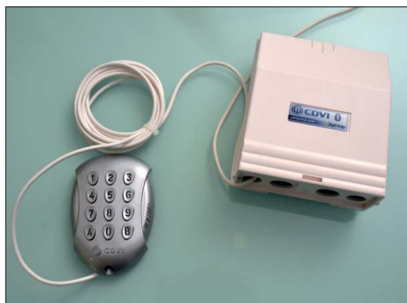
Le Digicode Galeo 4.0 et son boîtier déporté à électronique sécurisée.
