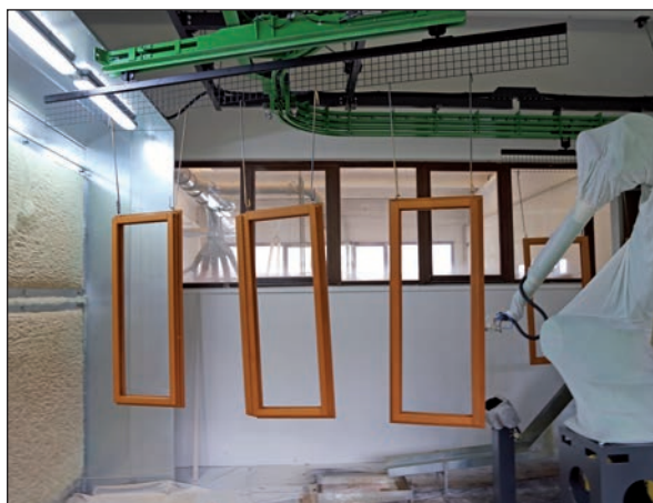
Robot de peinture pour peinture liquide sur PVC, bois, alu et acier, pour peinture poudre sur alu et acier, en version cadres de menuiseries de 4 m de longueur et 3 m de hauteur utiles, en version profils de menuiseries de 7 m de longueur utile, intégrable sur les lignes de peintures existantes pour augmenter leur capacité de production.
