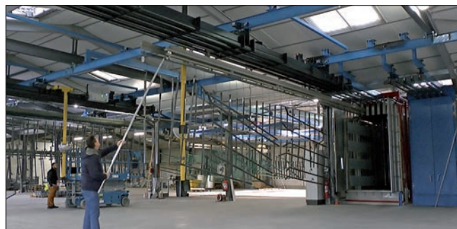
Machcoat Standard 5. Charges grandes dimensions pour portails (longueur 16 m, hauteur 2.8 m, largeur 1.2 m) avec gamme pour l'acier avec désoxydant et pour l'al.
