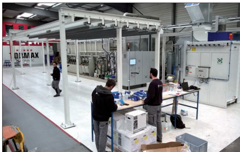
Machcoat Optima 1 vient d'être installée chez Lacroix (fabriquant de portes sectionnelles automatiques). Petite installation compacte de thermolaquage avec gamme de traitement type Qualicoat
