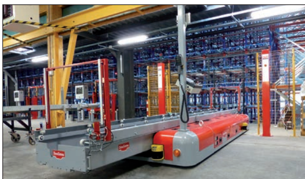
Le transtockeur de 2600 alvéoles représente un budget de 2,6 millions d'euros et permet d'éviter les manipulations de barres et les ports de charge importante en usine.
