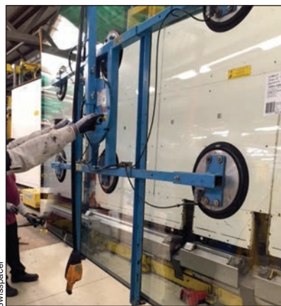
Le recours à une structure de levage ajoutée aux ventouses garantit une manipulation stable et empêche l'action de cisaillement.
