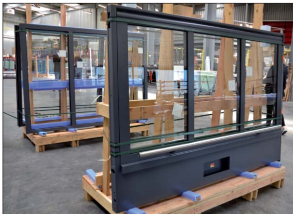
Dans l'usine, une porte d'entrée pour hall d'immeuble prête pour l'expédition (avec une réserve pour le contrôle d'accès)
