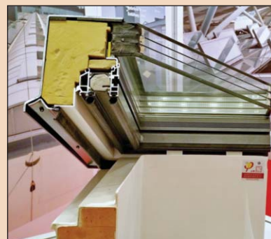
Lamilux a certifié trois modèles de lanterneaux au standard Passivhaus. Ils font appel à du quadruple vitrage avec menuiseries aluminium, complétés par une injection de mousse polyuréthane et plusieurs rupteurs de ponts thermiques.
