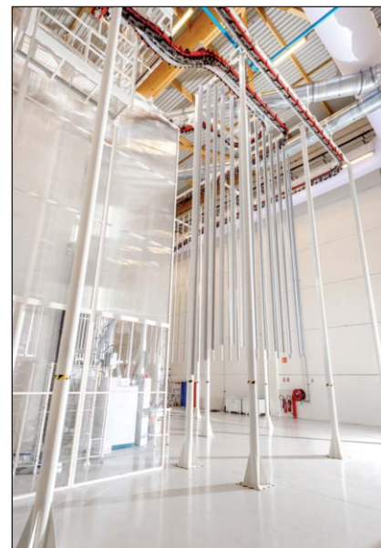
Chaîne de laquage verticale avec un traitement de surface sans chrome - certifié Qualicoat et Qualmarine
