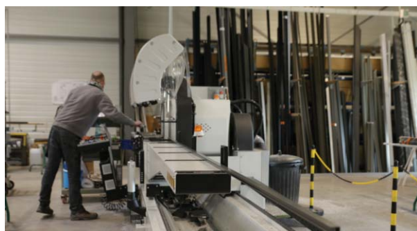
Le poste de débit
