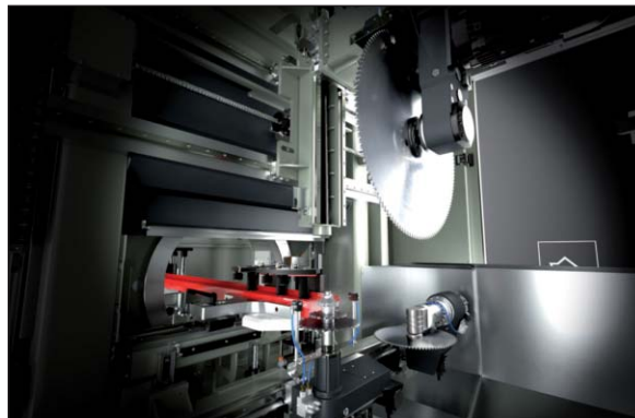
Vue d'ensemble des deux groupes «Lame» et de la tête de fraisage en bout du centre d'usinage Quadra L2.
