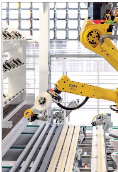
Protection des barres laquées par un robot scotchreur
