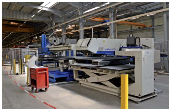
La machine à laser combinée avec une poinçonneuse.
