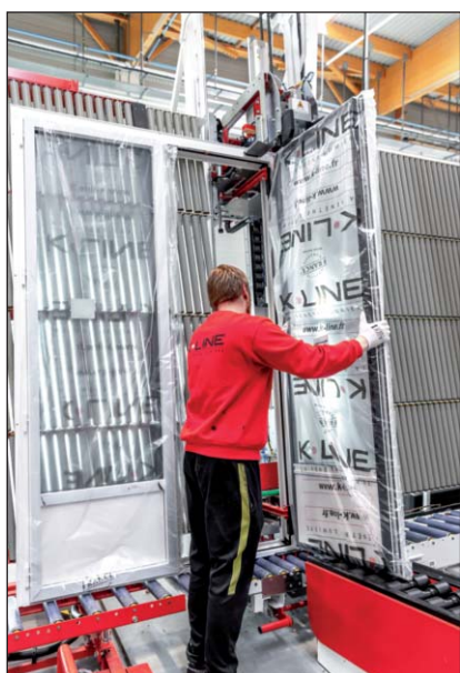
Engondage des ouvrants et contrôle du fonctionnement et de la qualité
