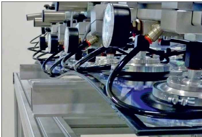
Un module TPedge avec verre de 2 mm durant un test de chargement.
